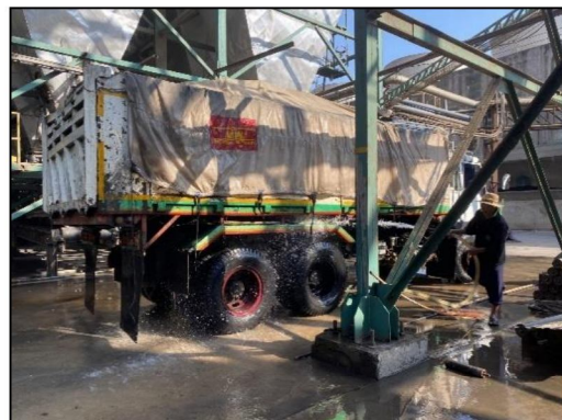
รูปที่ 49 การล้างล้อรถบรรทุกก่อนออกจากโรงไฟฟ้า
