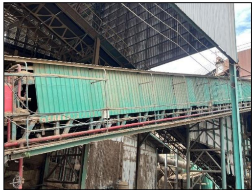
รูปที่ 4 ระบบสายพานลำเลียงแบบครอบปิด
